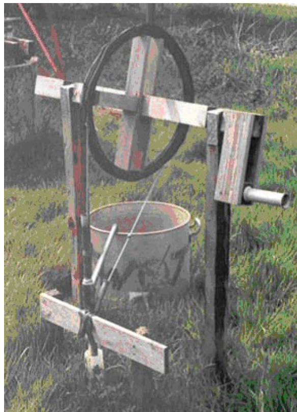
Touwpomp: eenvoudige en nuttige technologie
